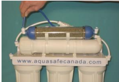
Fig. 21. Ligne bleu branchée dans le raccord du coude sur le côté gauche du filtre de résine DI.
