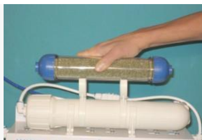
Fig. 17. Cartouche de résine DI prêt à être poussé en place
